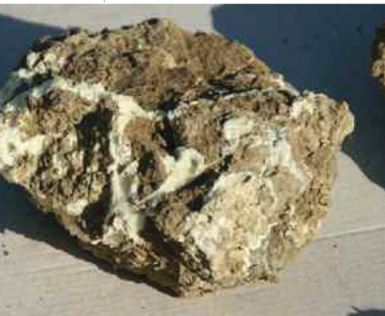
Campione terreno trattato con resina
